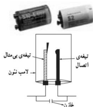
شکل (۲-۴) : شمای ظاهری و ساختمان داخلی استارتر
