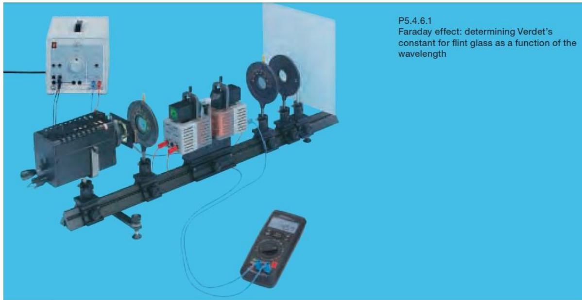
شکل ۲: چینش آزمایش اثر چرخش فارادی
