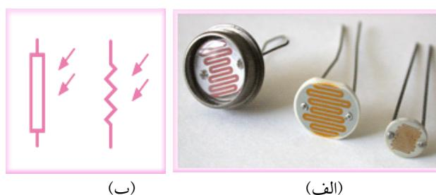
شکل ۱-الف) علامت مداری LDR و ب) عکس‌هایی از چند LDR
