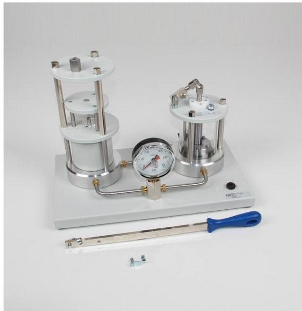
شکل ۳: عکس دستگاه پرس هیدرولیک
