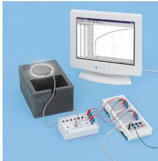
شکل ۱: ابزارها و دستگاه‌های بررسی مقاومت یک ابرسانا در دماهای بالاتر از دمای نیتروژن مایع
