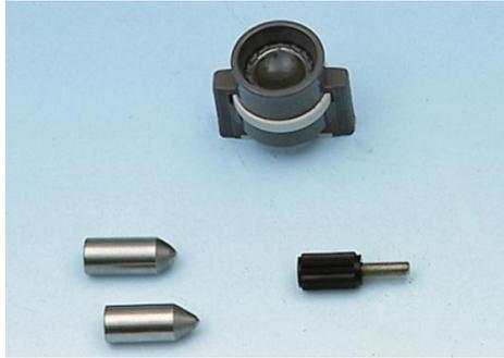
شکل ۲: چشمی، نوک‌های فرورونده ۲/۵۰ و ۵/۰۰ میلی‌متری و پیچ نگهدارنده‌ی آن‌ها.
