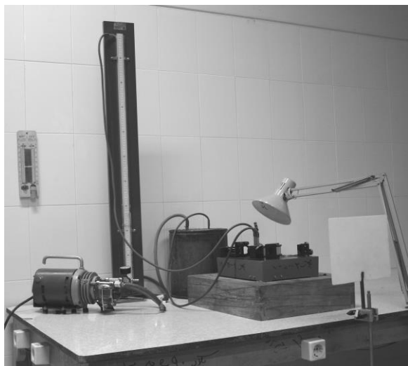
شکل ۲- دستگاه تداخل‌سنج مایکلسون برای اندازه‌گیری نمارشکست هوا
