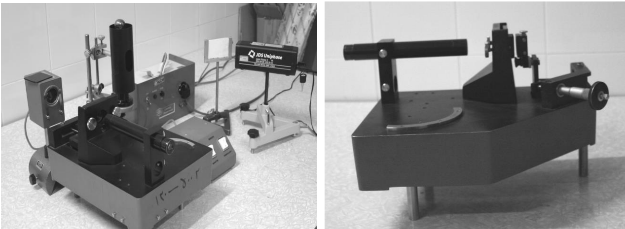
شکل ۲- برپایی تداخل‌سنج فابری-پرو
