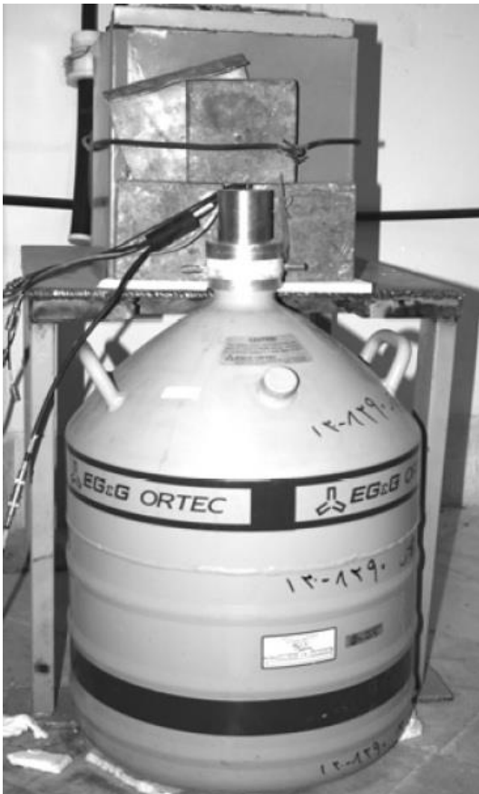
◀ شکل ۶: نمونه‌ای از یک آشکارساز HPGe (High Pure Ge) دانشگاه اصفهان
